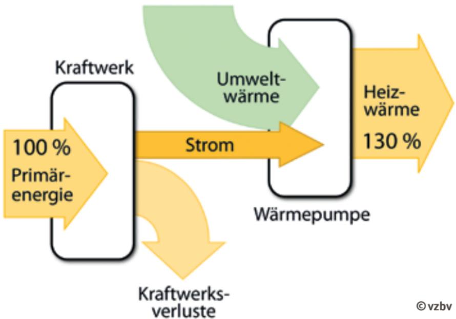
Energiebilanz einer Wärmepumpe mit Jahresarbeitszahl vier
