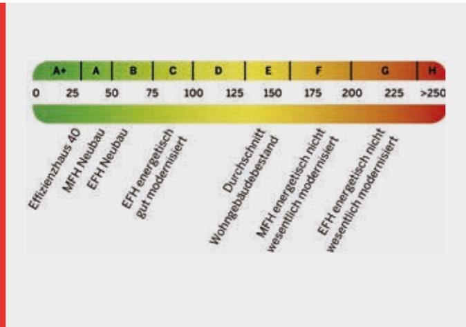
3. Energieausweise geben, neben den Energiekennwerten, auch die Energieeffizienzklasse eines Gebäudes an. Der Standard reicht von A+ (Passivhaus) bis H (unsanierte Gebäude). Die Skala reicht von 0 bis > 250 kWh/(m<sup>2</sup>a). Bisher war es so, dass die Skala auf dem Bandtacho auf > 400 kWh/(m<sup>2</sup>a) begrenzt war.
