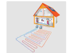
Wärmepumpe mit horizontalen Erdkolllektoren
