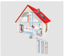
Wärmepumpe mit Erdwärmesonden
