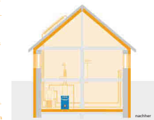
Heizungsleitung und Wärmedämmung: Nach einer umfassenden Wärmedämmung des Gebäudes wird nur noch eine geringere Energieleistung benötigt.
