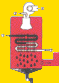
Brennwertkessel (neure Bauart)
