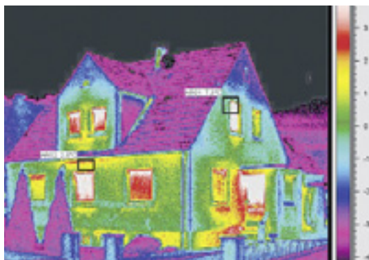
Wärmebild macht's möglich: Damit zeigen die Experten auf, wo Wärme aus dem Haus entweicht.
