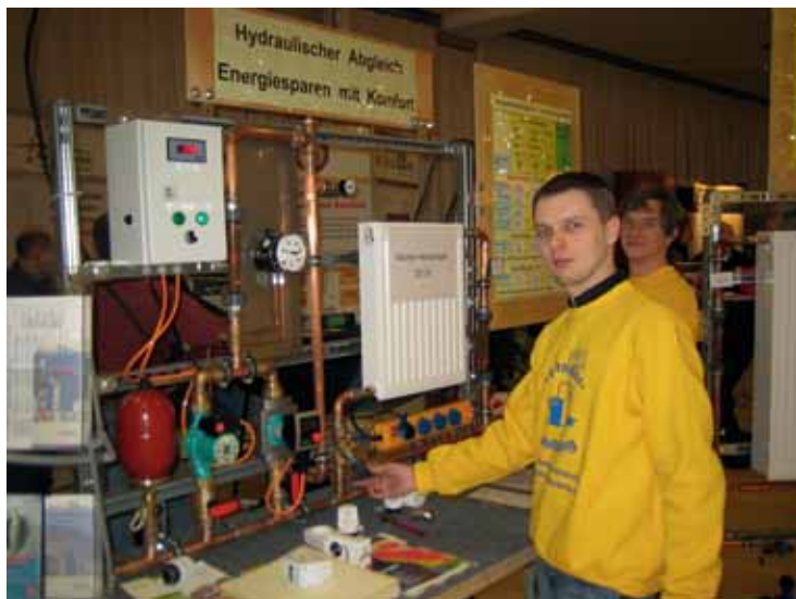
Bild 6: Schüler der Technikerklasse Heizung, Sanitär und Klima des Reckenberg-Berufskollegs demonstrieren am Heizungsmodell den hydraulischen Abgleich.
