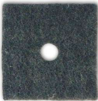
In der Geschirrspülmaschine gereinigter Filter
