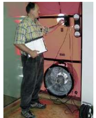
Qualitätskontrolle durch einen Luftdichtheitstest (Blower-Door-Test)
