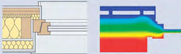
Einbausituation eines Holzfensters in eine Holzrahmenkonstruktion. Um die Wärmebrückenwirkung des Blendrahmens zu verringern, wird er außen mit einem Dämmstreifen überdeckt.
