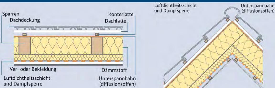
Zwischensparrendämmung kombiniert mit Untersparrendämmung, bei ausgebautem Dachgeschoss auch als nachträgliche Verbesserung der Wärmedämmung, kann ohne Ab- und Neueindeckung des Daches erfolgen. Dabei verringert sich allerdings die lichte Raumhöhe. Statt Dämmplatten zwischen den Sparren kann der Zwischenraum auch bei dieser Lösung mit einer Einblasdämmung gefüllt werden, wenn das Dach eine Schalung auf der Oberseite der Sparren aufweist.
