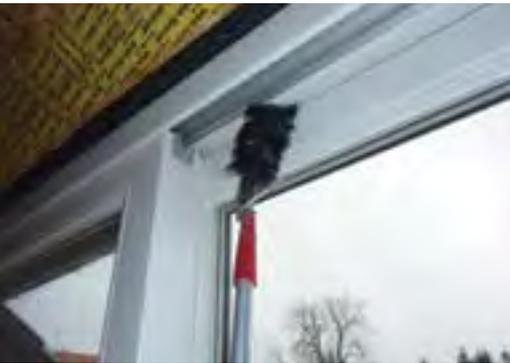
Prüfung mit Feder am Fenster
