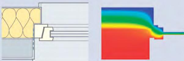
Wird beim Einbau eines Kunststofffensters in eine Massivbauwand mit Wärmedämmverbundsystem der Rahmen deutlich überdämmt, minimiert sich die Wärmebrücke.
