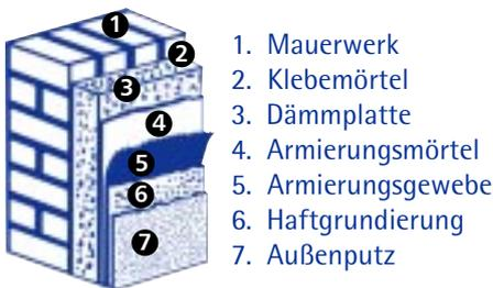
Bild 10: Aufbau der Thermohaut
