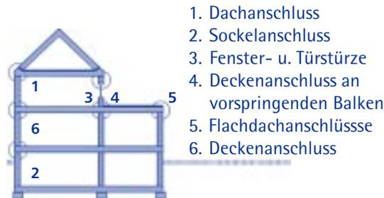
Bild 12: Typische Wärmebrücken
