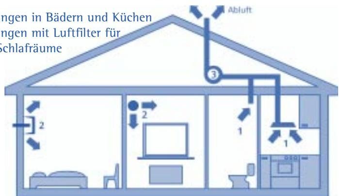
Bild 31: Lüftungsanlage mit Abluftventilator
