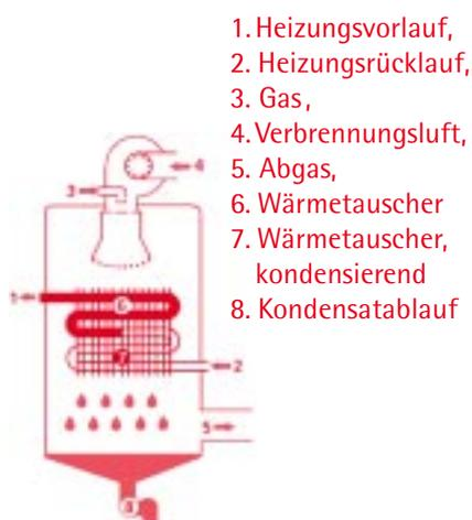
Bild 24: Brennwertkessel
