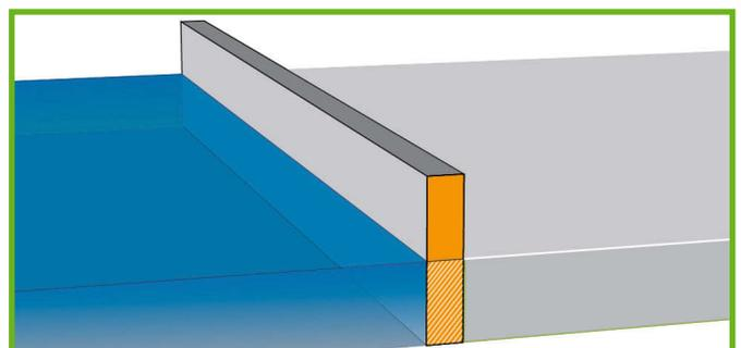
17 Unterirdische Abdichtung einer Schutzmauer
