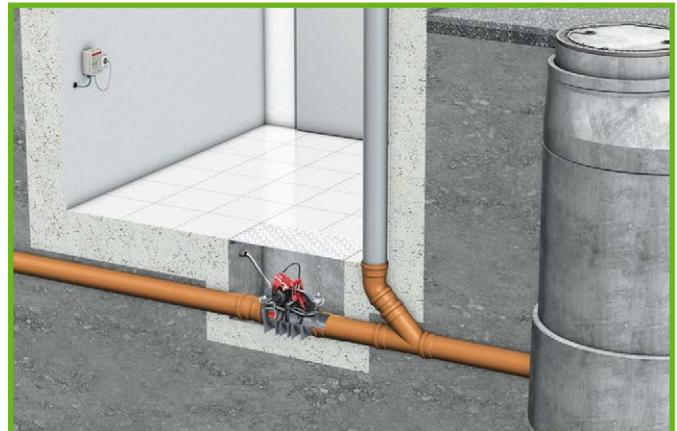
40 Funktionsweise einer Rückstauklappe
