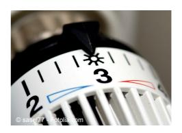
Das Thermostatventil "fühlt" mit. Es sorgt unabhängig von der Außentemperatur für immer dieselbe Raumtemperatur. Das Ventil schließt automatisch, wenn die eingestellte Temperatur erreicht ist. Es öffnet sich erst wieder, wenn diese unterschritten wird. Ist das Fenster oder die Tür offen, wird so lange (dauer-)geheizt, bis die am Ventil eingestellte Temperatur, trotz Kaltluftzufuhr, erreicht ist.
