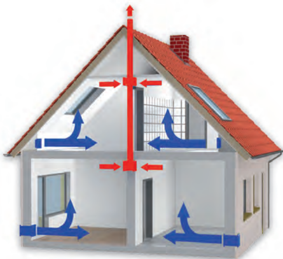
Lüftungsanlage mit Abluftventilator (ohne Wärmerückgewinnung) und dezentralen Zuluftöffnungen (Außenluftdurchlässen)
